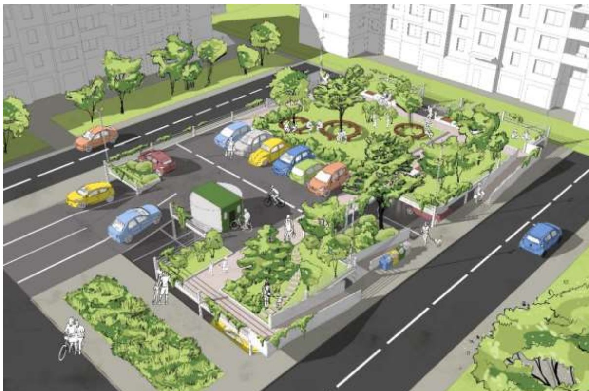
Figură 98 - Mod de amenajare parcare 2 nivele cu nivelul superior axat pe spatiu verde si locuri de parcare vizitatori Sursa: Portofoliu consultant
